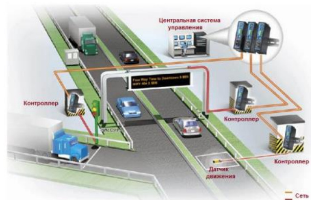
Рисунок 1.1 - Принцип действия АСУДД
